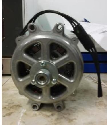
Figura 2.1: Generador síncrono de imanes permanentes de 1.6 kW de potencia nominal.
