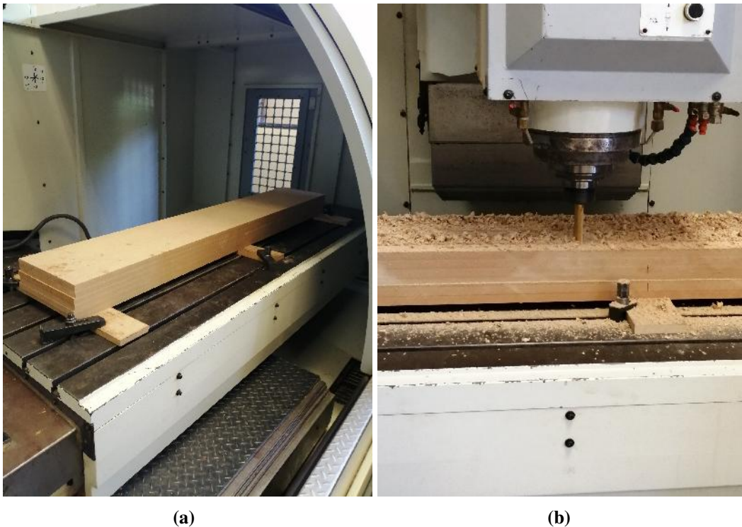
Figura B.2: Maquinado para la construcción del molde: a) adecuación del espacio de trabajo y de la pieza a maquinar, y b) maquinado del molde en proceso.
