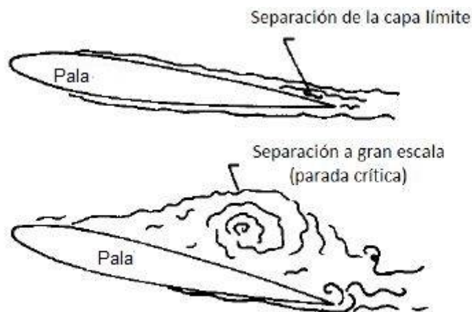
Figura 2.19. Separación stall. Fuente: [28].
