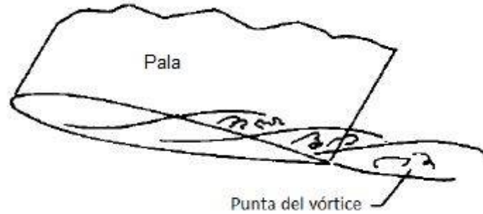
Figura 2.20. Formación de vórtice en la punta de la pala. Fuente: [28].
