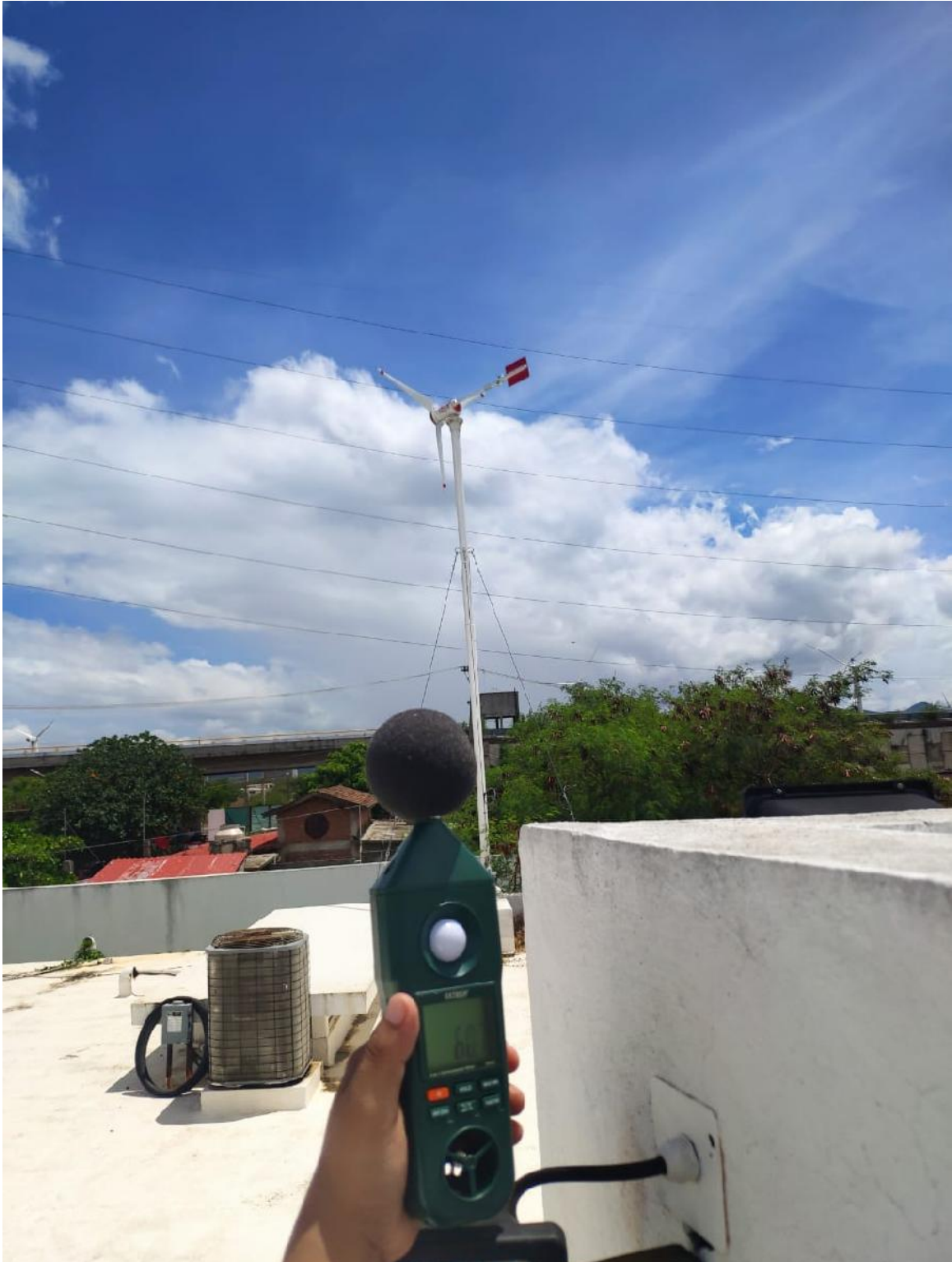
Figura 4.4. Midiendo los niveles de presión sonora emitidos por el aerogenerador.
