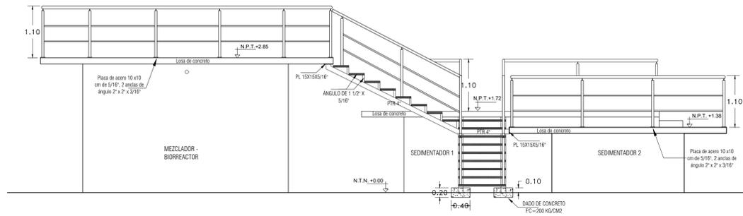
**DETALLE 3.- ALZADO ESCALERA METÁLICA Y BARRANDALES**
