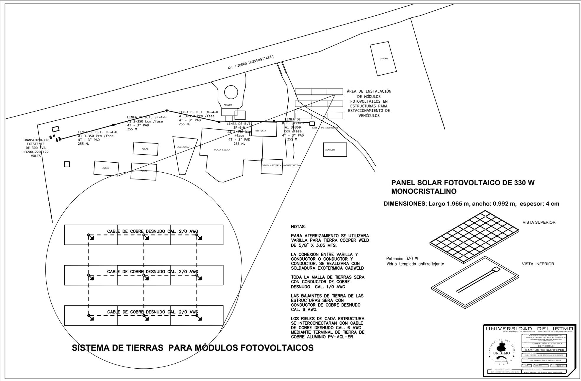
**PANEL SOLAR FOTOVOLTAICO DE 330 W MONOCRISTALINO**
